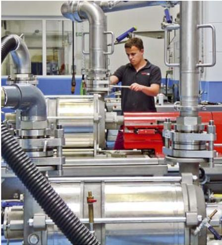
Computergesteuerte und vollautomatisierte Prüfstände für Vakuumpumpen im Werk von Speck in Roth. Messung von Hydraulik, Leistungsbedarf und Schwingungen. Prüfungen bis zu einem Ansaugdruck von 5 mbar und bis zu einem Saugvermögen von 2.000 m³/h.
