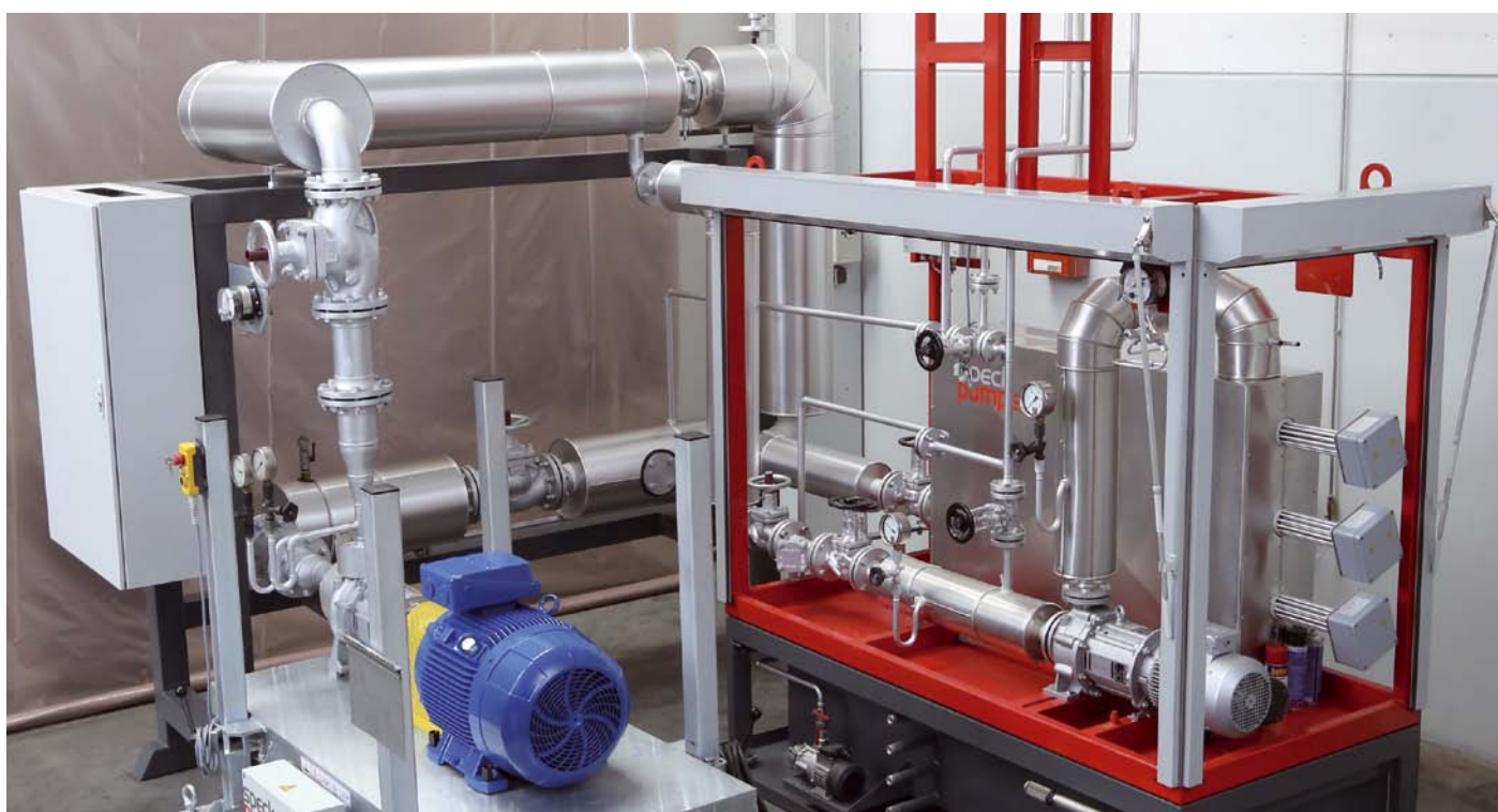
Banc d'essai d'huile thermique avec système de surveillance des pompes à l'usine de Speck à Roth. Étude de l'impact de températures élevées allant jusqu'à 350 °C sur la durée de vie des pompes.
